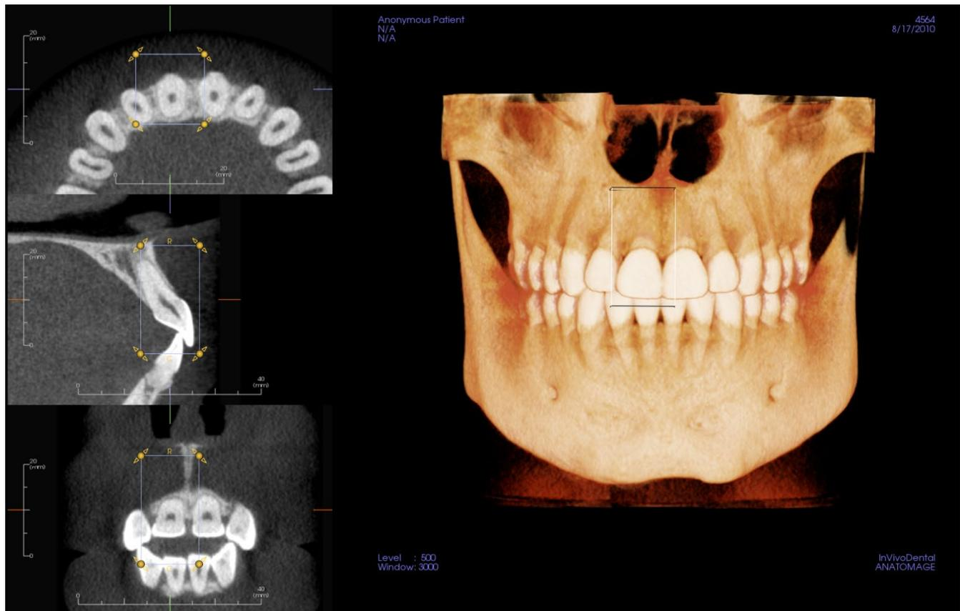
A caixa pode ser ajustada com o widget nos cortes 2D. Clique e arraste a caixa para movê-la. Clique e arraste os nós amarelos para redimensioná-la. Clique e arraste as setas para girá-la. Pressione a tecla "a" para realinhar a caixa com o corte.
