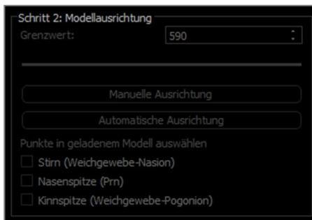
Das texturierte Hautmodell kann nun entweder manuell mit dem Widget-Tool oder automatisch, wenn die Weichgewebeprofile des Falles nachgezeichnet wurden, an das Volumen angepasst werden. Der automatische Ausrichtungsprozess beinhaltet das Platzieren von Orientierungspunkten auf dem texturierten Hautmodell.
